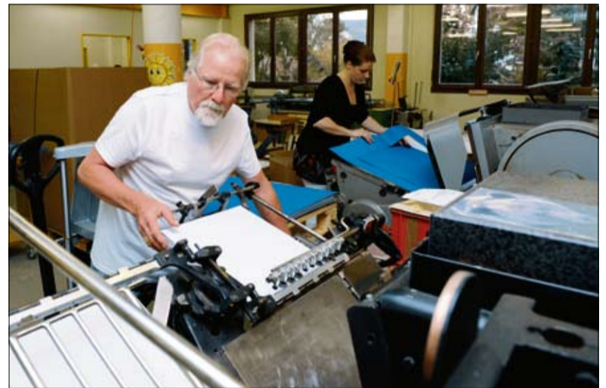
An einer für diesen Zweck umgebauten Heidelberger Druckmaschine werden Kartonprodukte gestanzt.
